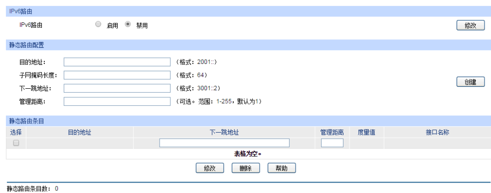
图 10-8 IPv6 静态路由条目
